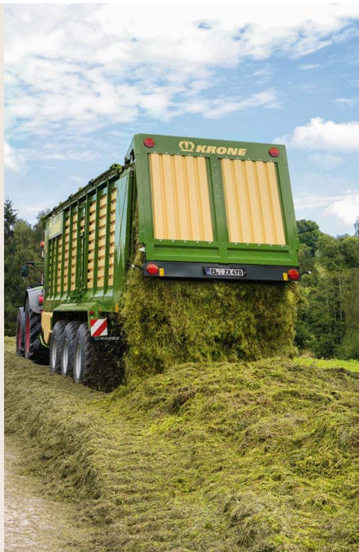
Beim Abladen auf dem Silo sollte eine möglichst gleichmäßige und dünne Schicht abgelegt werden. Dies klappt besonders gut, wenn optionale Dosierrollen am Ladewagen montiert sind.
