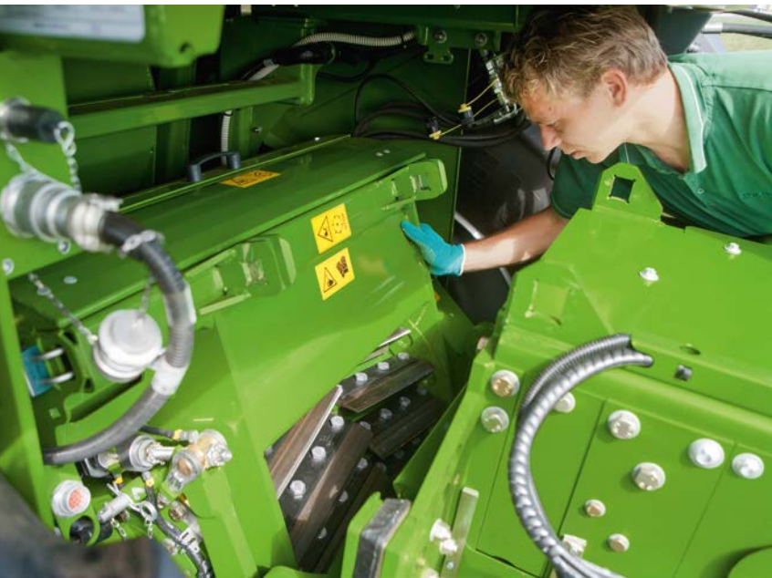
Eine regelmäßige Sichtkontrolle der Messer und der Gegenschneide wird von den Experten empfohlen. Bei Krone-Häckslern kann der Einzug dafür mit angebautem Vorsatz V-förmig geklappt werden.
