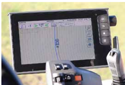
Über TaskDoc wird der Auftrag dem Fahrer übermittelt.
